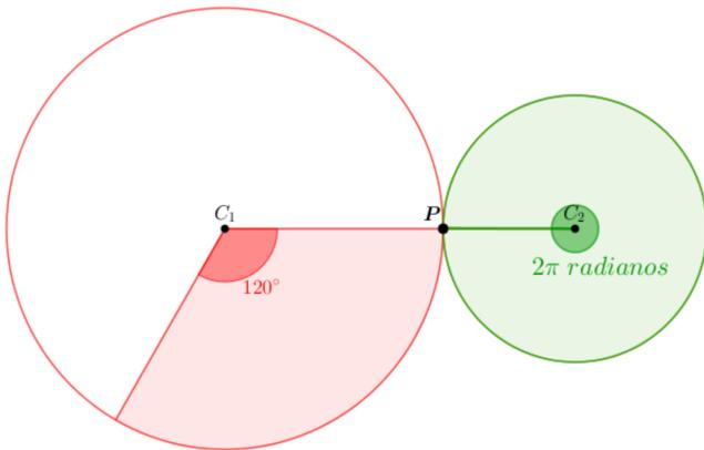
Como a Roda 1 girou  $120^\circ$  e a Roda 2 girou  $2\pi$  radianos, a partir do ponto  $P$  ficam definidos um arco na circunferência da Roda 1 cuja medida angular é  $120^\circ$  ou  $\frac{2\pi}{3}$  radianos e um arco na circunferência da Roda 2 cuja medida angular é  $360^\circ$  ou  $2\pi$  radianos.
